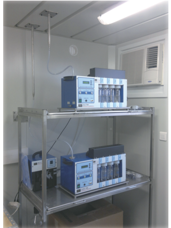
Barboteurs Tritium MARC 7000 et carbone 14 HAGUE 7000 installés sur bâti inox avec cannes de prélèvement atmosphérique.
