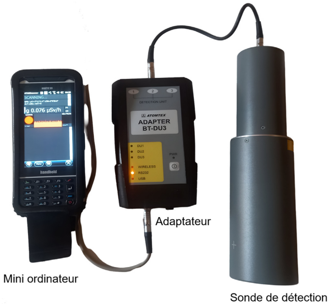
Fig. 1. Photographie du spectromètre AT6101C(E), utilisé dans cette étude pour la mesure du débit d'équivalent de dose ambiant gamma.
