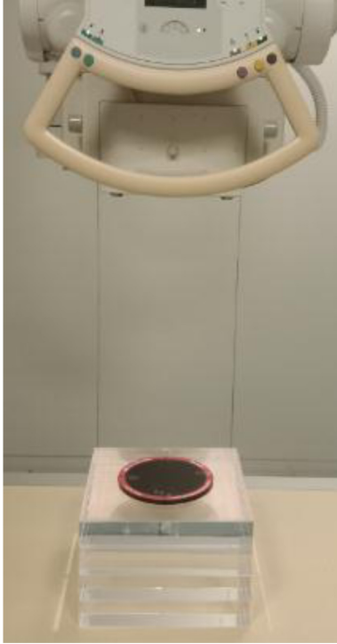
Fig. 1. Photographie du montage pour l'exposition de l'objet test permettant l'évaluation de la qualité d'image de l'ASP couché.
