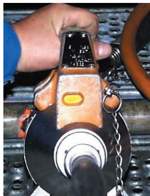
Figure 5 – Signal jaune : le projecteur est sur le chantier, la source rentrée et l'appareil déverrouillé par sa clé de sécurité individuelle. Yellow signal: the camera in on work place, source inside, and un-locked.
