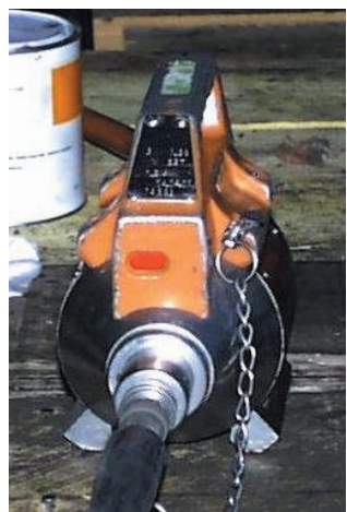
Figure 6 – Signal rouge : l'exposition peut être réalisée, l'obturateur est ouvert après action sur le loquet d'armement prévu à cet effet, la source est éjectée ou prête à être éjectée. Red signal: the exposure can be carried out, the obturator is open after action on the latch of armament envisaged for this purpose, the source is ejected or lends to being ejected.
