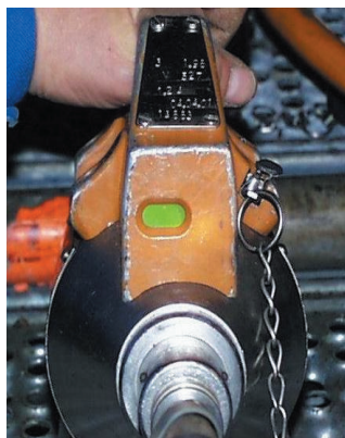
Figure 4 – Signal vert : le projecteur est en position de stockage, la source rentrée et l'appareil verrouillé. Green signal: the camera is in position of storage, and locked.
